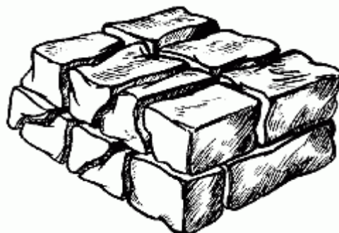
Рис. 21. Кладка, разрезанная вертикальными плоскостями камней
